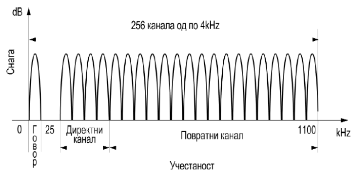
Slika 6 Raspored kanala kod ADSL sistema sa DMT
