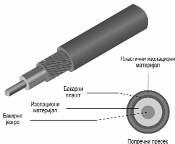
Изглед и попречни пресек коаксијалног кабла
